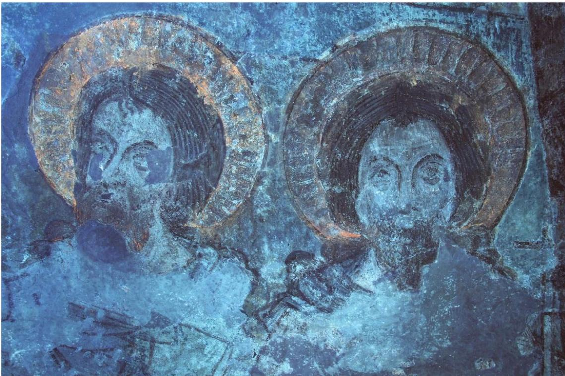
Die Reste des Anlegemittels der Nimben fluoreszieren orangefarben unter UV-Licht.
