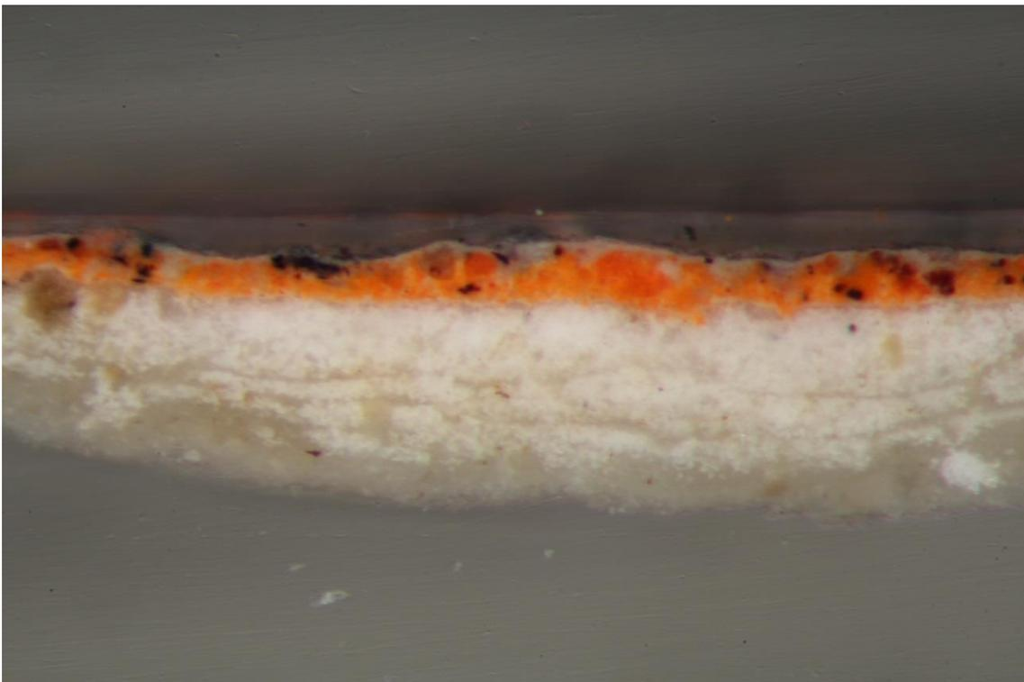
Die dreilagige Kalkschlämme hat nur vereinzelt Zuschläge und besteht ausschließlich aus Calciumcarbonat. Darauf liegt eine orangerote Farbschicht mit schwarzen Einschlüssen, welche aus Bleimennige, ausgemischt mit Bleiweiß besteht, welches teilweise oxidiert ist. Darauf liegt eine dünne graue Farbschicht, bei der es sich um die Retusche handelt. Hier wurde Bleiweiß mit feinem Schwarz analysiert. Ein organisches Bindemittel ist nicht zu erkennen. (Analyse: Prof. Dr. Jägers, Bornheim, 18.12.2015).
